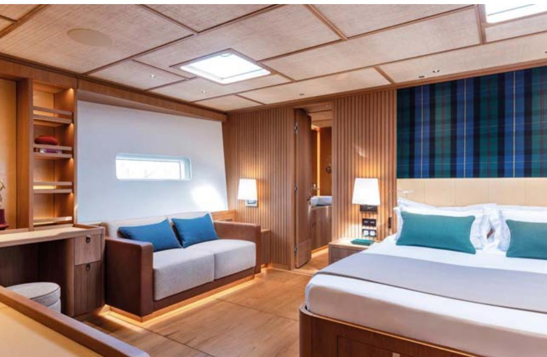
L'appartamento armatoriale è configurato con cabina e bagno entrambi a tutto baglio. Infinite le possibilità di personalizzazione, data l'ampiezza degli ambienti e i vincoli strutturali ridotti della zona, ben delimitata da paratie dalla forma regolare. Le varie cabine ospiti possono assumere diverse configurazioni con letti singoli o matrimoniali, ulteriori letti pullman e bagni completabili con bidet.
